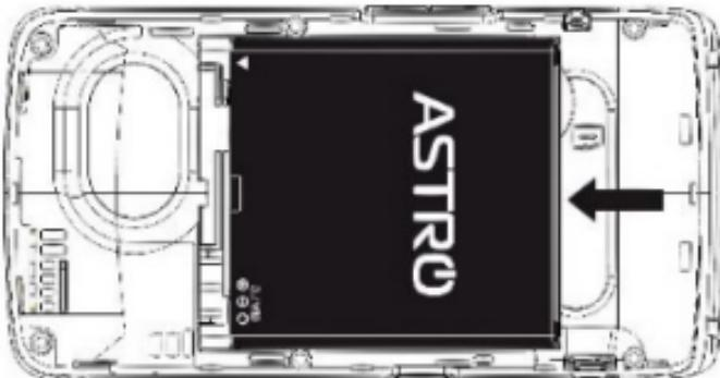
После верного размещения батареи закройте крышку и плотно прижмите ее к корпусу.
