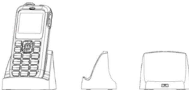
Разъем для подключения USB-кабеля расположен с задней стороны подставки.
